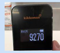
実験用のまな板のルミテスターによる
